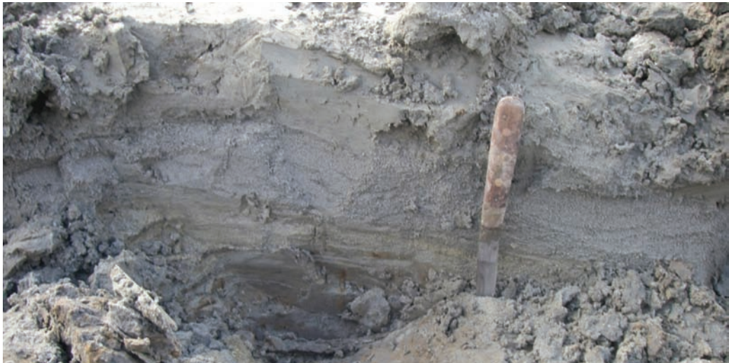
Afbeelding 18. Een kalkrijke zwak siltige zandlaag tussen de finer gelaagde frequentie van siltige klei.
